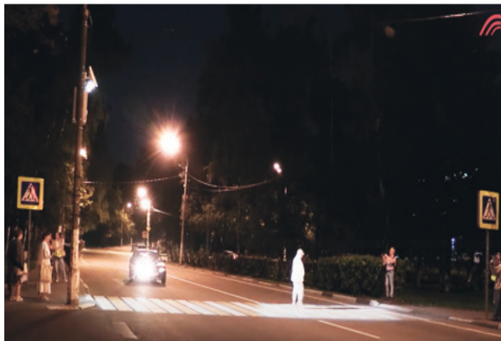
Рисунок 6 – Применение системы дополнительного освещения пешеходов на пешеходном переходе «Умный переход» (г. Красногорск, ул. Маяковского)
