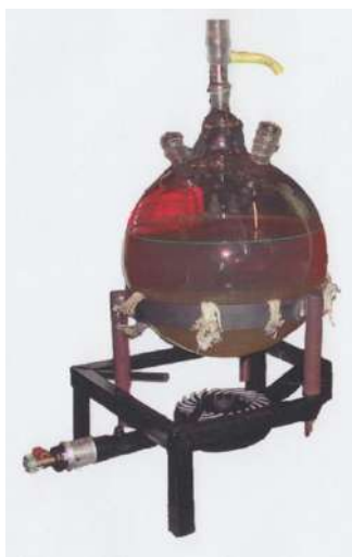
Рис. 1. Самодельный лабораторный реактор на газовой горелке
