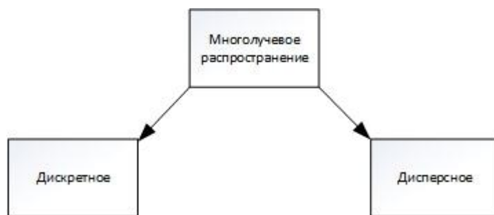
Рис. 1. Виды многолучевого распространения
