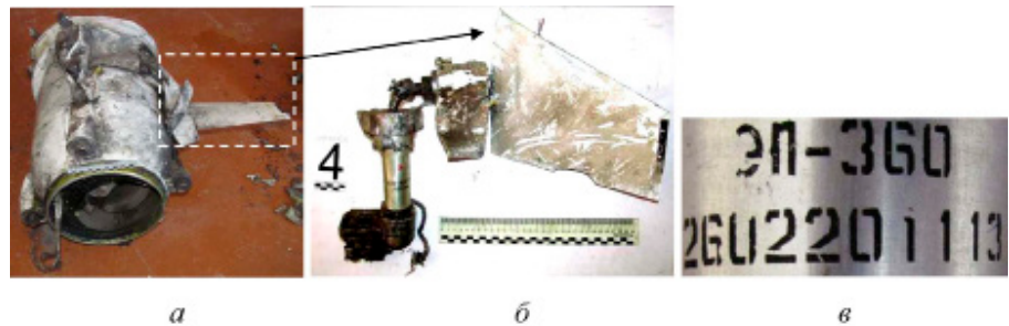
Рис. 10. Хвостовой руль ракеты: а – его расположение на двигателе; б – внешний вид с приводом; в – маркировочные обозначения на корпусе привода, выполненные красящим веществом черного цвета
