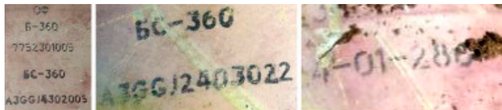
Рис. 15. Маркировочные обозначения на боевой части ракеты Р-360: а, б, в – расположенные сбоку (поз. «в» содержит основные производственные сведения); г – расположенные с торца и содержащие основные производственные сведения. ОФ – обозначение типа осколочно-фугасной боевой части, Б-360 – вероятно, обозначение индекса боевой части
