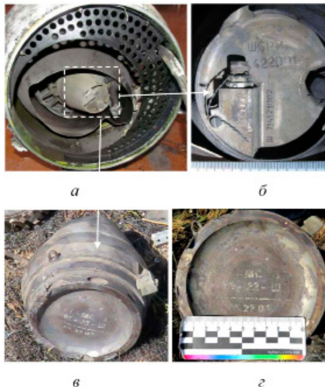
Рис. 11. Хвостовой конус турбины двигателя МС-400: а – расположение в турбине; б – внутренняя полость; в, г – внешний вид. Маркировочные обозначения выполнены различными способами
