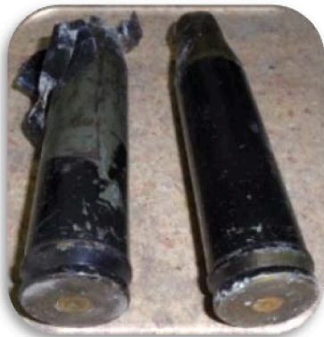
Гранаты, изготовленные из гильзы от орудия калибром 23 мм
